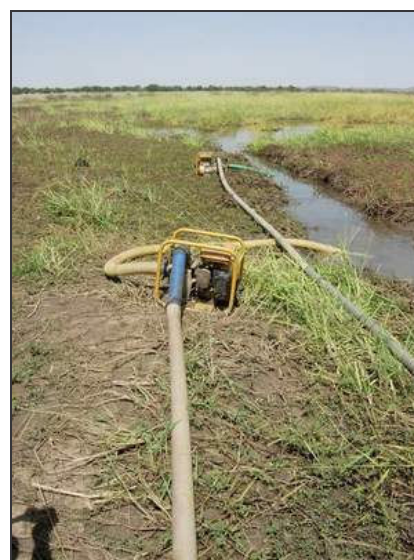
Figure 8. Groupe motopompe type Robin et Yamaha (Luc J.Ph. 2006).
