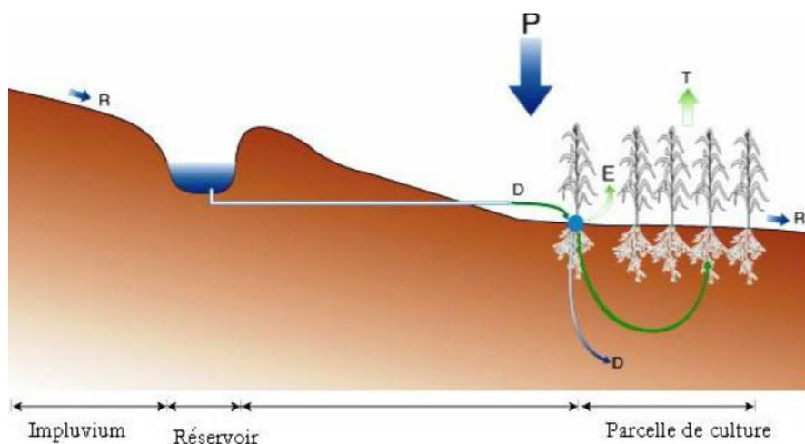
Figure 1: Principe de l'irrigation de complément (Source : Fox , 2003).
